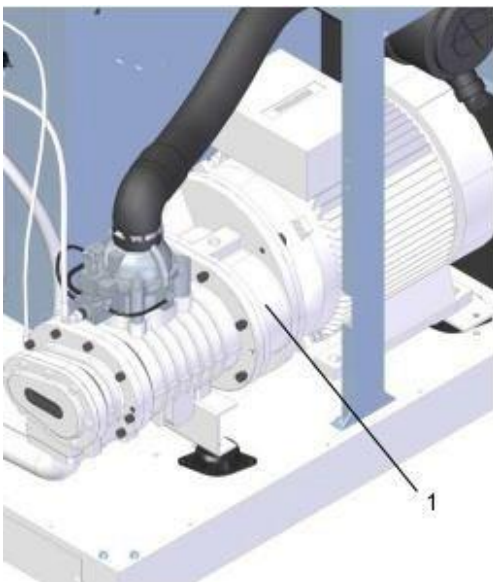
Рис. 5: Винтовой компрессор с приводом через встроенный в винтовой блок редуктор
